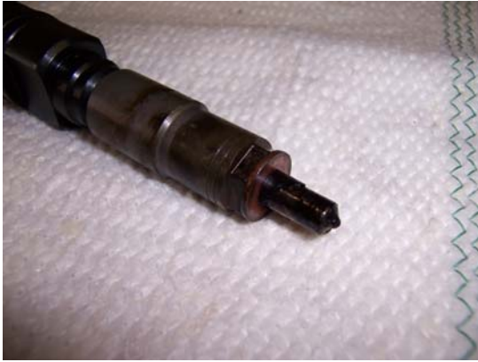
Abbildung 15: Einspritzdüse JD 7430, 1.750 Bh, Rapsölbetrieb
