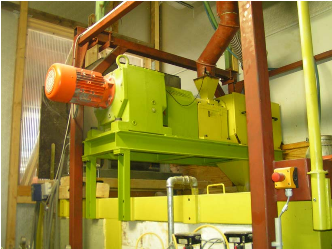
Abbildung 2: Ölpresse der AG „Bergland“ Clausnitz e.G. (Foto: T. Krüger)
