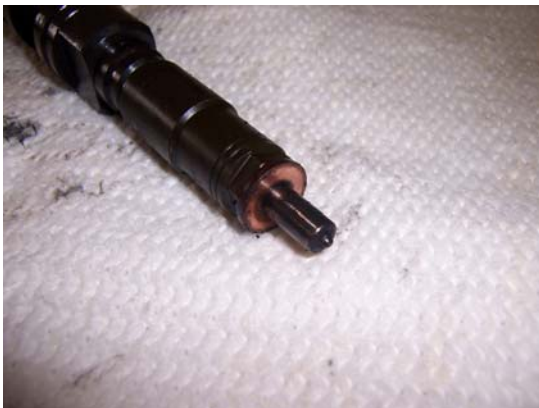
Abbildung 14: Einspritzdüse JD 7430, Dieselbetrieb (Foto: K. Nürnberger)
