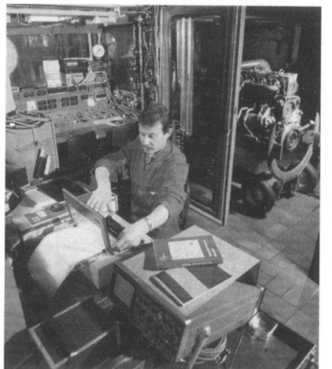
Konstruktion im Werk Elsbett: Auf dem Bildschirm wird ein neues Teil entworfen (oben); die Fertigung ist bis hin zu Werkstück- und Werkzeugwechsel automatisch gesteuert (Mitte); Text und Optimierung des Motors erfolgen durch umfangreiche Messungen während des Betriebs (unten).
