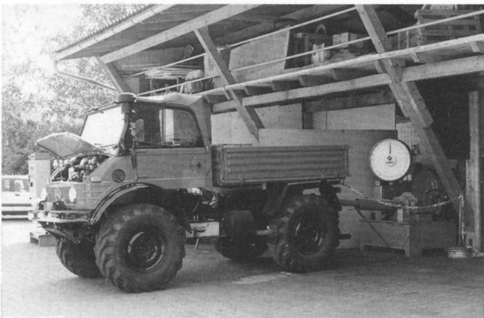
Links Mitte: das vom Bayerischen Wirtschaftsministerium geförderte „Eiserne Pferd“, rechts der Generator, links die Ölmühle und Filterpresse. Nicht zu sehen ist der sogenannte Crasher zum Zerkleinern der Ölnüsse.
